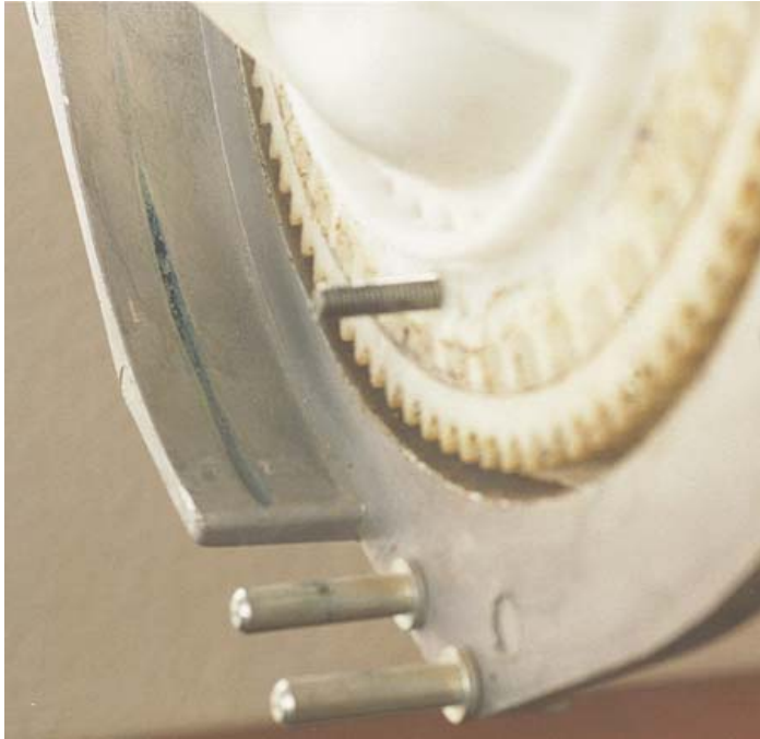
Figuur 8. Bij dit zaaihuis is een slijtgroef zichtbaar.
