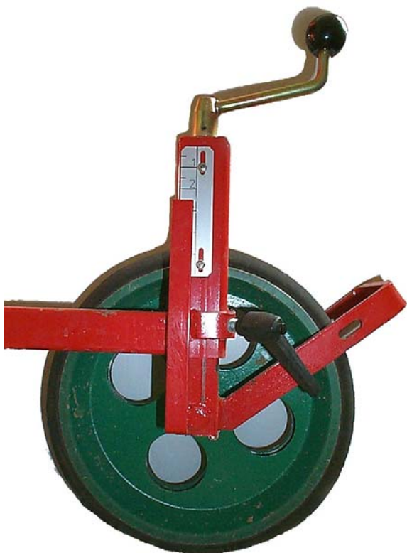
Figuur 10. Een verstelbare aanduiding van de zaaidiepte.
