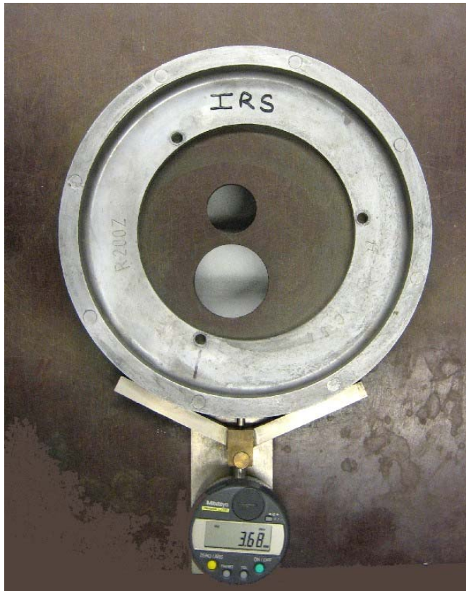
Figuur 12. Een micrometer meet de celdiepte van de schijf.
